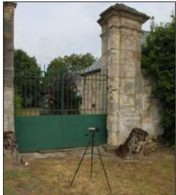
Mesure sonore n°2 en zone d'émergence réglementée
