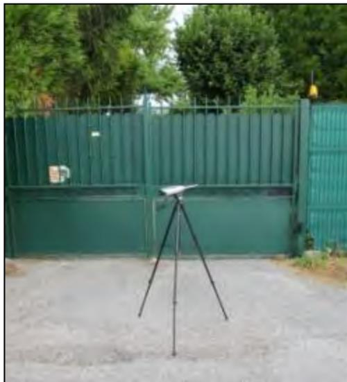
Mesure sonore n°3 en zone d'émergence réglementée
